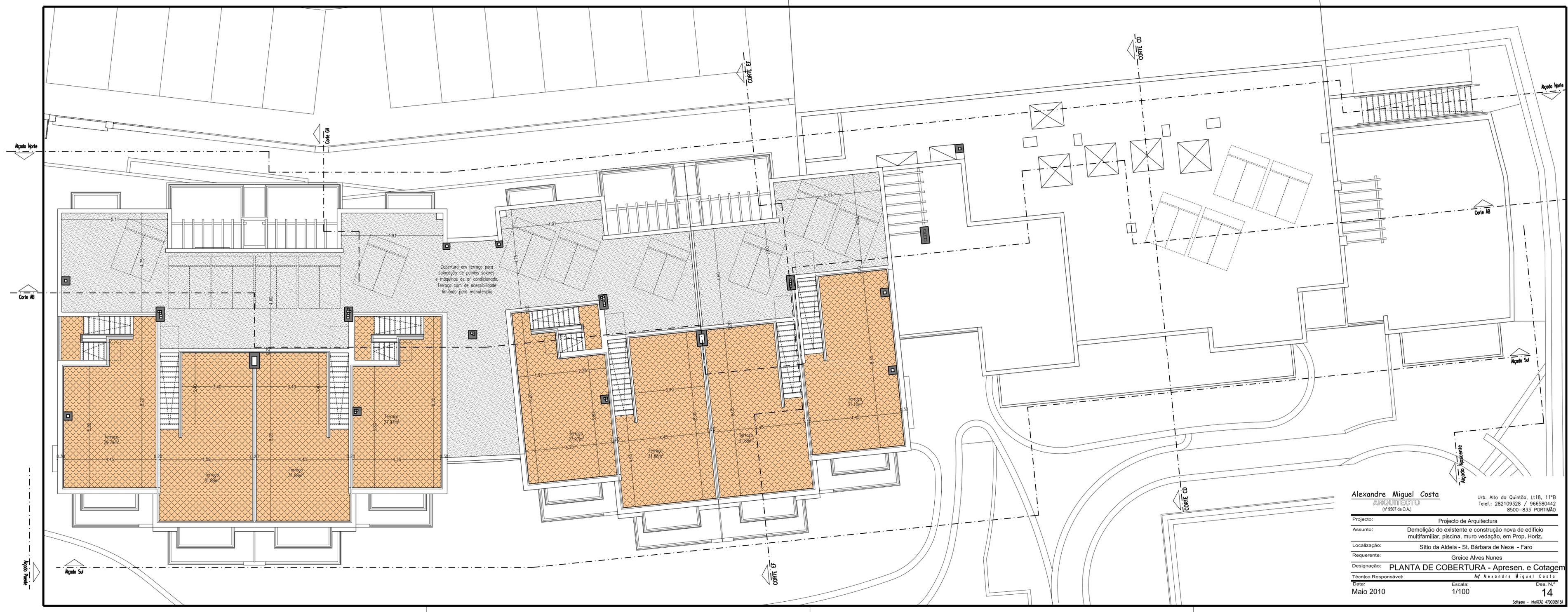
Cobertura em terraço para colocação de painéis solares e máquinas de ar condicionado. Terraço com de acessibilidade limitada para manutenção.
